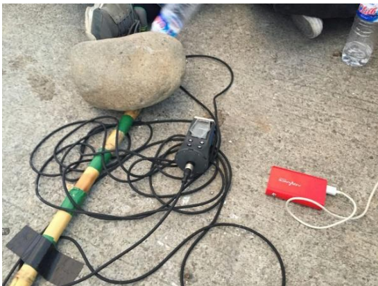
Gambar 7. Seperangkat alat currentmeter dipasang pada alat bantu (bambu)
