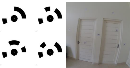
Gambar 2. Coded Targets 12 bit dan pemasangan pada objek
