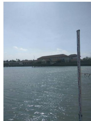
Gambar 8. Palembang pasut ( tide staff ) untuk pengukuran tinggi muka air laut
