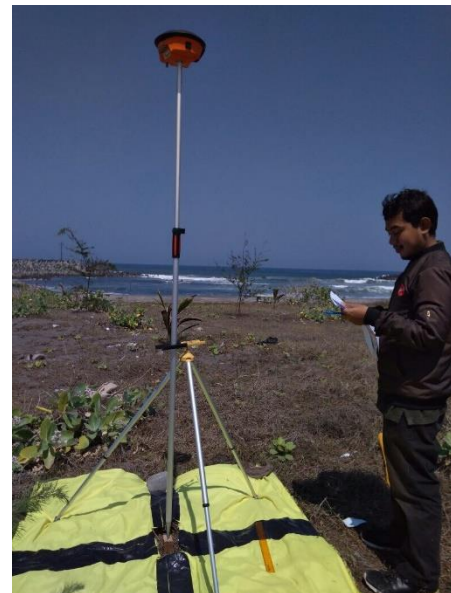
Gambar 4. Pengukuran titik kontrol menggunakan GPS
