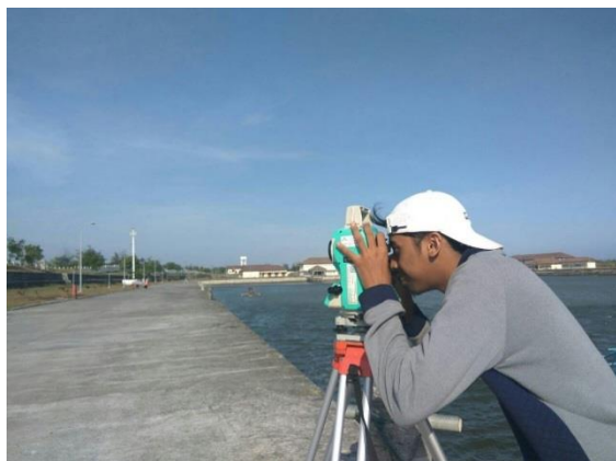
Gambar 9. Akuisisi data detail situasi menggunakan Total Station
