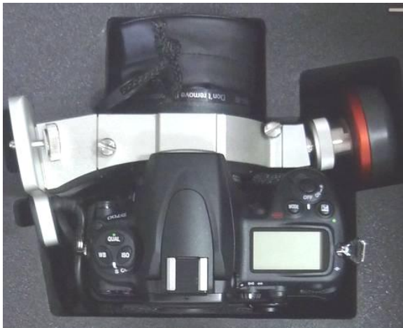
Gambar 7. Unit kamera Nikon D700 dengan lensa fix wide 14 mm dan internal GPS
