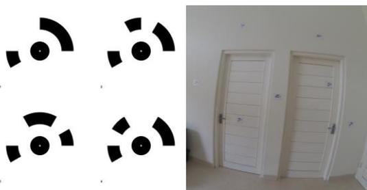
Gambar 2. Coded Targets 12 bit dan pemasangan pada objek
