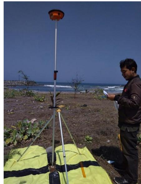
Gambar 4. Pengukuran titik kontrol menggunakan GPS
