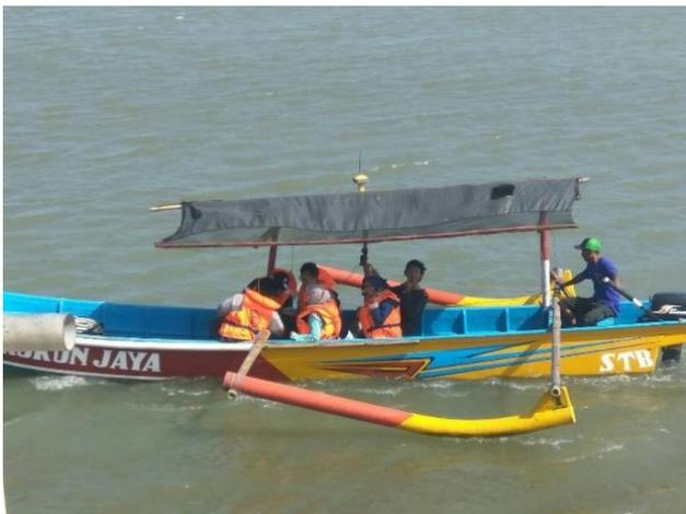
Gambar 6. Proses akuisisi data batimetri menggunakan kapal
