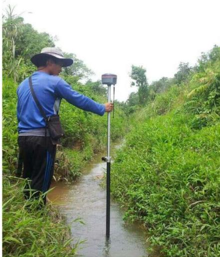
Gambar 8. RTK Rover pada blank spot
